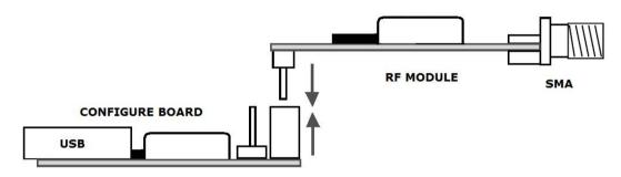
模块和配置板的连接示意图
